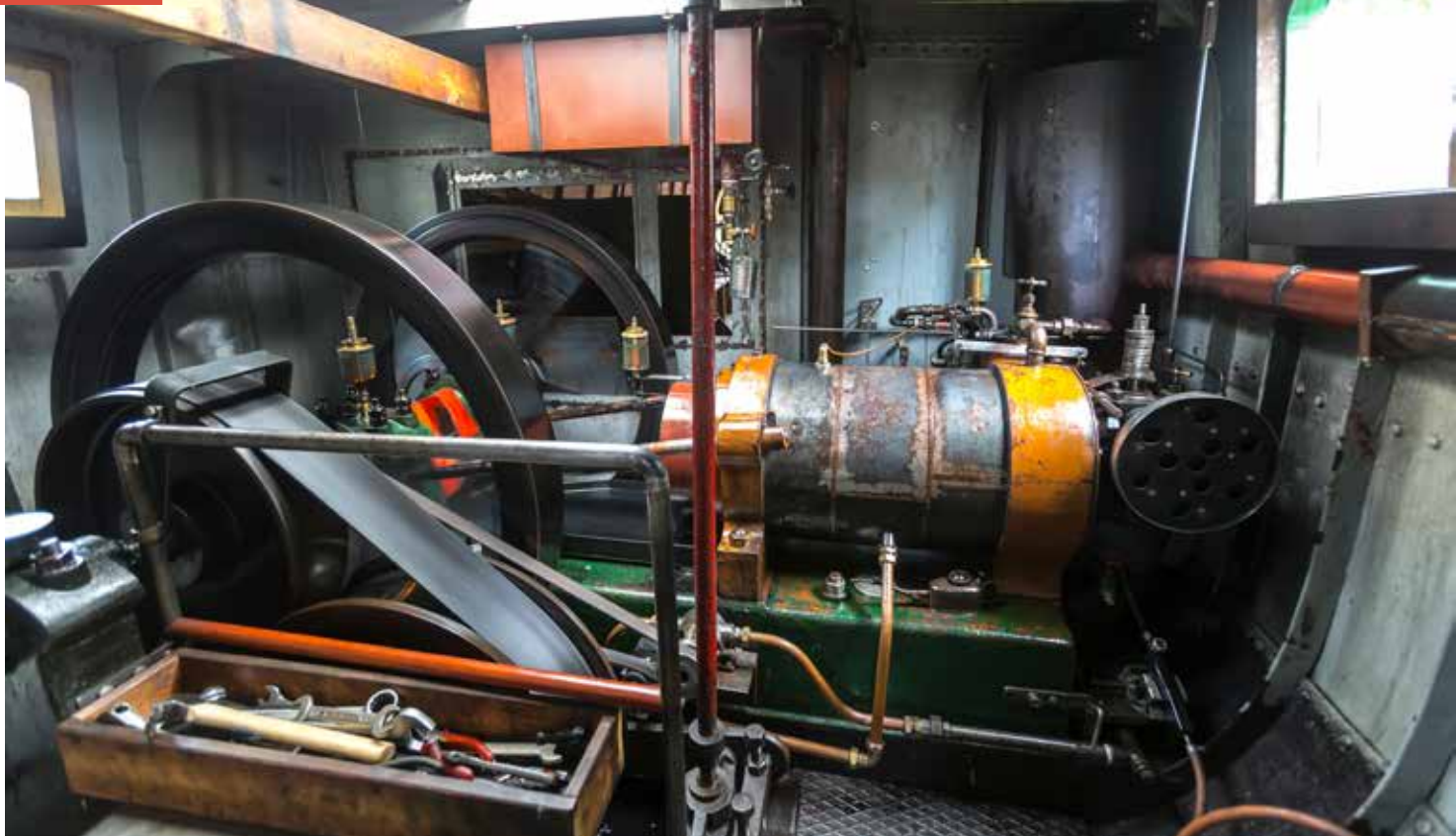
De liggende Van Rennes met op de voorgrond de grote wielen van de keerkoppeling · Foto Berthel Kolthof
