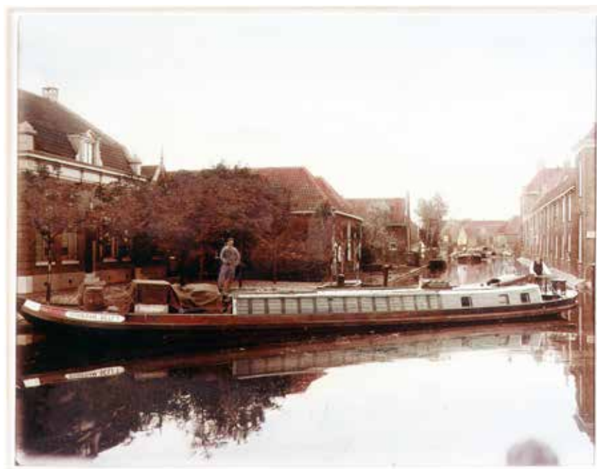
Deze foto van een andere motorpakschuit, Schiedam-Delft, was zeer nuttig bij het restaureren van onder andere de verticale opstaande houten luiken Bron Maritiem Museum Rotterdam
